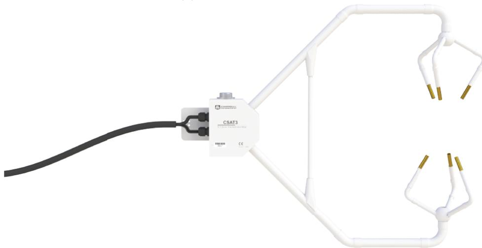
(b) Sonic anemometer (CSAT3).
